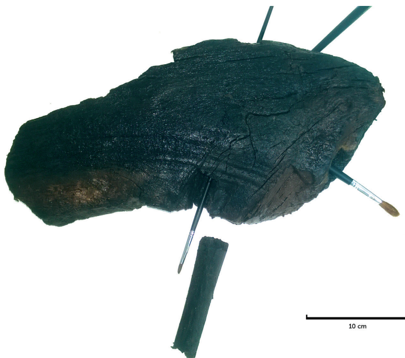
Fig. 1. Foto med illustration af naglernes placering. Længdemål på det store stykke 35cm. Naglernes placering er på fotoet illustreret med pensler. Nagle A (længst tv) er gennemgående. Nagle C (længst th) løber på tværs på nagle A.
