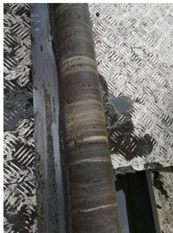
Figur 3 Registrering og overførsel af sedimentkerner til halverede plastrør
