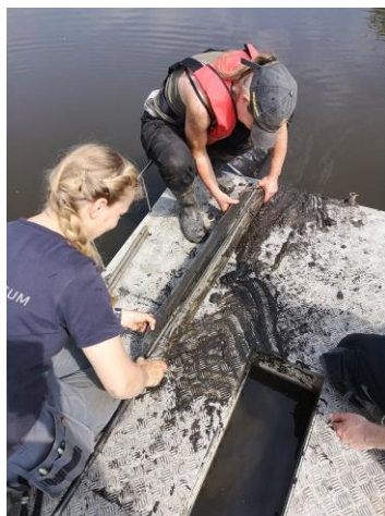
Figur 3 Registrering og overførsel af sedimentkerner til halverede plastrør
