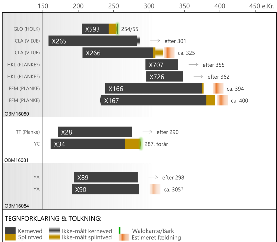
Figur 1: Dateringsdiagram for de tre lokaliteter OBM 16080, OBM 16081 og OBM 16084. Undersøgelsens dateringer placeret på en tidsskala med angivelse af årringssekvensernes længde og konstateret kerneved, splintved, waldkante osv. De beregnede fældningstidspunkter for de undersøgte prøver er noteret i forlængelse af hver prøves årringssekvens. Fældningstidspunkterne er beregnet vha. splintstatistikker (se evt. Metodebeskrivelse i rapportens bilag); for egetræ: 20 [-5+10] årringe i splintved. For prøver med waldkante/bark er det absolutte fældningstidspunkt noteret.
