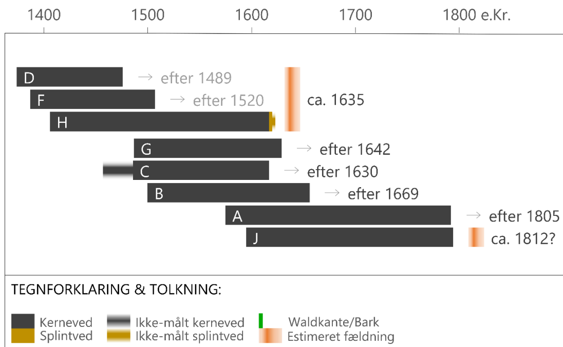
Figur 1: Dateringsdiagram for tømmeret fra Tranebjerg Præstegård. Undersøgelsens dateringer placeret på en tidsskala med angivelse af årringssekvensernes længde og konstateret kerneved, splintved, waldkante osv. De beregnede fældningstidspunkter for de daterede prøver er noteret i forlængelse af prøvernes årringssekvens. Fældningstidspunkter er beregnet vha. splintstatistikker (se evt. Metodebeskrivelse i rapportens bilag); for egetræ 20 [-5+10] årringe i splintved. For prøver med waldkante/bark er det absolutte fældningstidspunkt noteret.
